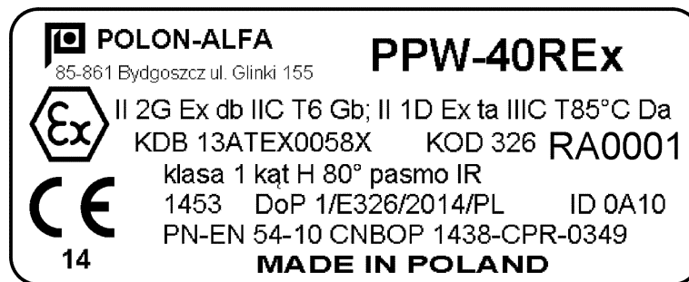
Rysunek 3.1 Tabliczka znamionowa zawierająca elementy oznaczenia
