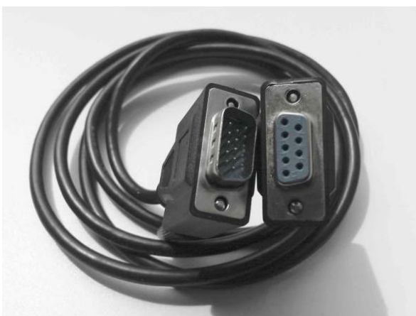
Fot. nr 6 – Przewód RS 232 do centralki
