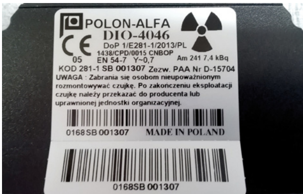
Rys. 11. Elementy obudowy (tabliczka znamionowa) jonizacyjnej czujki dymu typu DIO-4046
