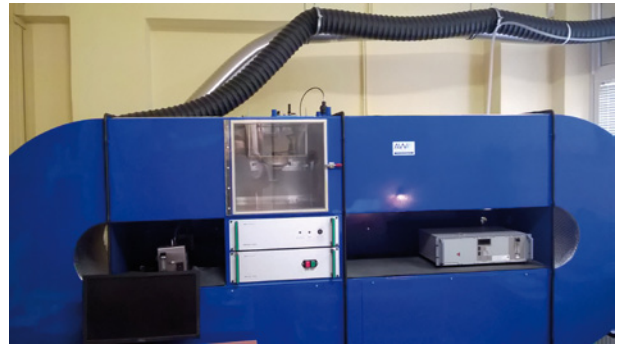
Rys. 12. Tunel parafinowy (kanał dymowy) do sprawdzania wartości progu zadziałania oraz wpływu kierunku przepływu powietrza na wartość progu
