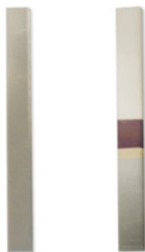
Rys. 8. Widok strony aktywnej w jednolitym kolorze srebrnym (po lewej stronie) oraz strony nieaktywnej z czarnym znacznikiem i żółtawym paskiem (po prawej stronie)
