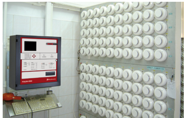
Rys. 13. Tablica do starzenia i testowania jonizacyjnych czujek dymu w Dziale Kontroli Jakości POLON-ALFA
