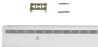
Rys. 9. Uchwyt źródła promieniotwórczego (po lewej stronie); strona aktywna i nieaktywna źródła ^{241}\text{Am} (7,4 kBq); typ APSD-HME-7,4
